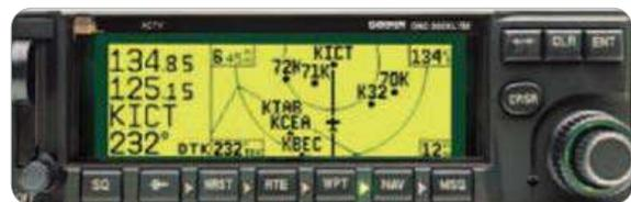
[그림 3-27] 지역항법을 위한 장비의 예시. 항공기 기종 또는 항공기 제작 시 선택한 사양에 따라 다양한 장비가 탑재된다.
