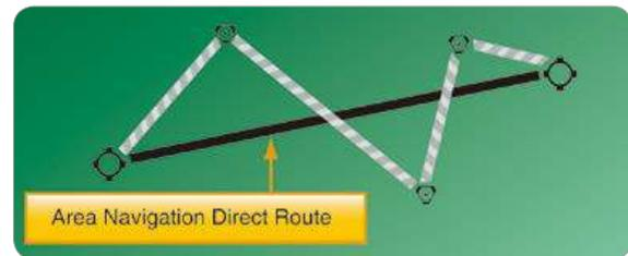
[그림 3-25] 지역항법 항로 설정의 개념. 항행안전무선시설을 지점으로 하지 않기 때문에 항로 설정이 자유롭고, 불필요한 비행거리가 줄어든다.
