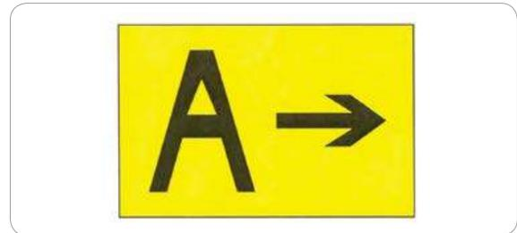
[그림 2-36] Direction Sign Array for Runway Exit
