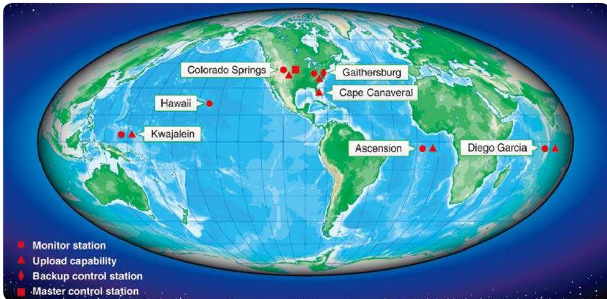
[그림 2-48] GPS의 지상관제(Control) 부분
