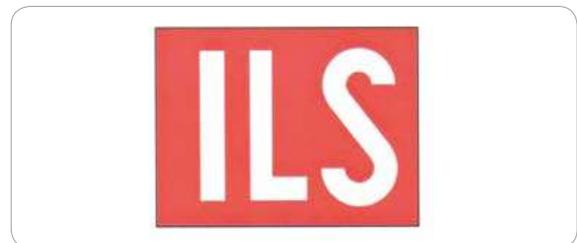
[그림 2-29] Holding Position Sign for ILS Critical Area
