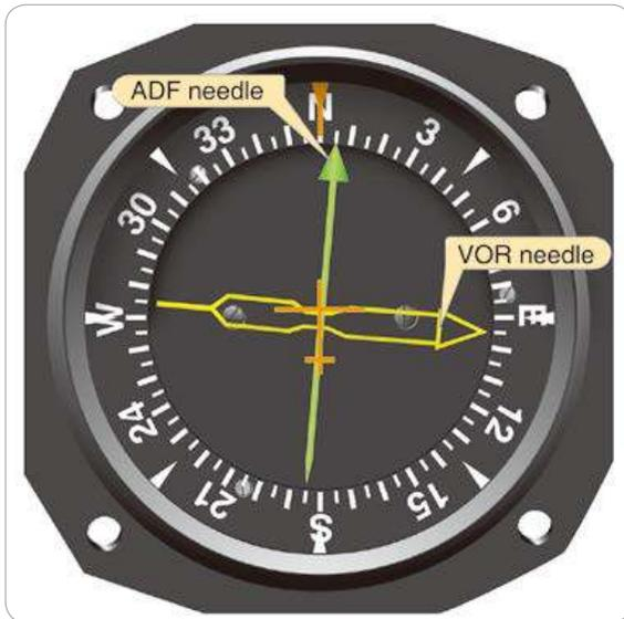
[그림 4-28] 알엠아이(Radio Magnetic Indicator)
