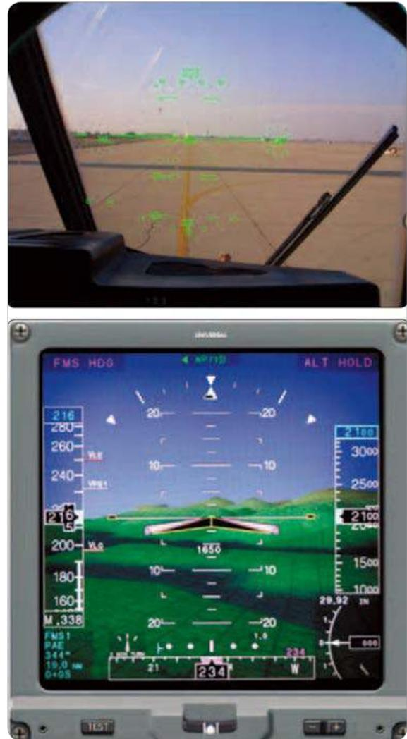
[그림 3-32] Head-Up Display(HUD)와 Head-Down Display(HDD)
