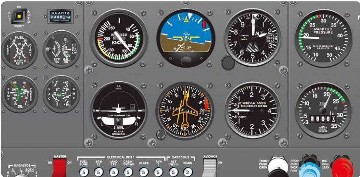
[그림 4-5] 진공 부작동(Vacuum failure)
