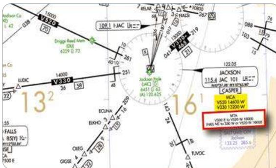
[그림 4-21] Minimum turning altitude(MTA)
