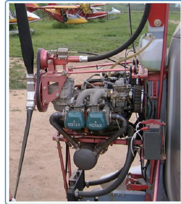
[그림 2-36] 엔진과 스핀업 장치
