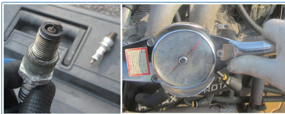
[그림 3-4] 점화플러그 및 토크렌치 사용
