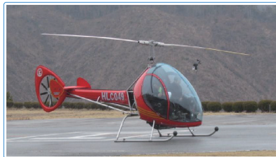
[그림 2-19] 경량헬리콥터 DANALY H2 (패네스트론 Tail Rotor)
